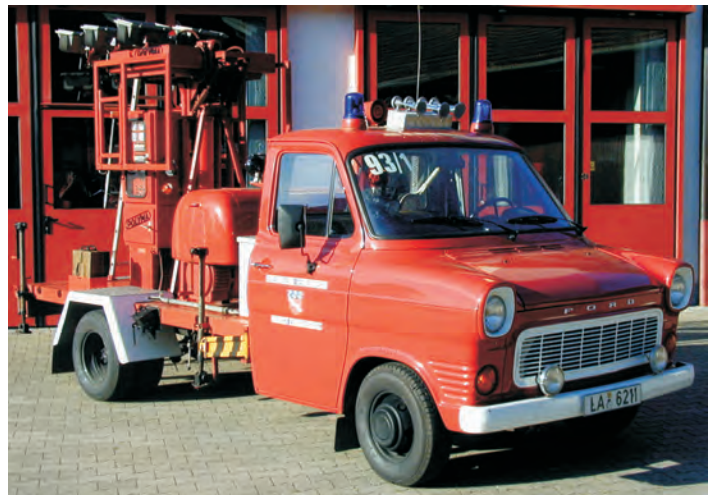
Erstes Lichtmastfahrzeug der Feuerwehr Ergoldsbach auf einem Ford Transit-Fahrgestell (Baujahr 1977).
